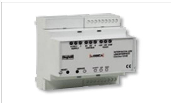
Interface zur Kommunikation mit einem Gebäudeleitsystem über einen LON-Bus. Steuerung: Dauerschaltung, Ein/Aus und Auslösung einer Funktionsprüfung. Meldung: Betriebsbereitschaft, Netzbetrieb, Batteriebetrieb, Netzausfall, Sammelstörung, Ladestörung, Batteriestörung, Leuchtenstörung, Busstörung.
