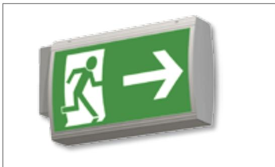
Rettungszeichenleuchte in architektonischem Design, bestehend aus Leuchtgehäuse in gewölbter Form. Oberfläche als Scheibe ausgeführt. Rettungswegkennzeichnung wahlweise 1-seitig (Wandmontage) oder 2-seitig (Decken-, Pendel- und Auslegermontage). Leuchte inklusive vier Rettungszeichenfolien, Adapter für Deckenmontage und Ausleger.
