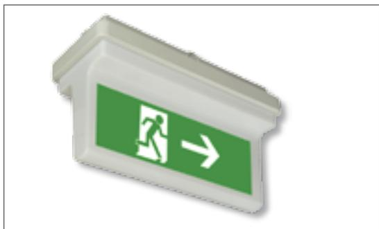
Rettszeichenleuchte in industriellem Design, bestehend aus flachem Gehäuse und dreieckiger, transluzenter Abdeckung. 2-seitige Rettungswegkennzeichnung (Decken-, Seil- und Auslegermontage). Leuchte einschließlich vier Rettungszeichenfolien, Adapter für Seilmontage und Ausleger. Besonderheit: industrieller Look, Erhöhung der Schutzart auf IP65 durch Zusatzgehäuse.
