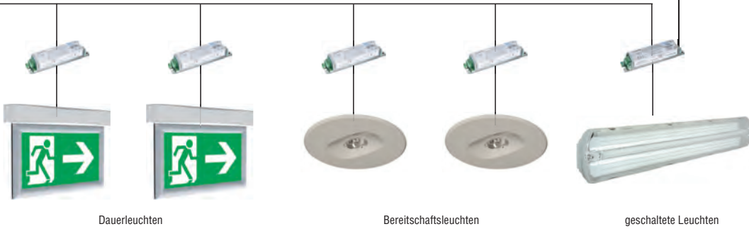
bis zu 36 Ausgangskreise mit je max 32 Leuchten
