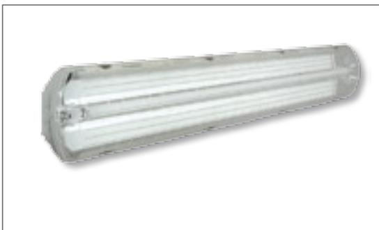
Sicherheitsleuchte in industriellem Design, bestehend aus gewölbtem Gehäuse und gewölbter Abdeckung. Abdeckung in transparenter Ausführung mit Längs- und Querprismen. Lichtlenkung durch hochglänzenden Reflektor aus aluminiumbeschichtetem Kunststoff, komplex geformt.
