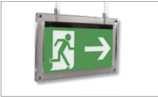
Rettungszeichenleuchte in funktionalem Design, bestehend aus einer Plexiglasscheibe mit integrierter LED-Leiste. Rettungswegkennzeichnung wahlweise 1-seitig (Wandmontage) oder 2-seitig (Deckeneinbau-, Pendel- und Auslegermontage). Leuchten ohne Rettungszeichenscheiben, die entsprechenden Varianten sind aber inklusive Seilpendel, Wandhalterung oder Ausleger. Besonderheit: funktionaler Look, Displaytechnologie und LED-Technik.
