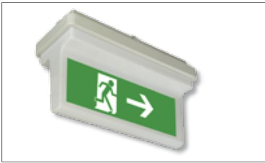
Rettszeichenleuchte in industriellem Design, bestehend aus flachem Gehäuse und dreieckiger, transluzenter Abdeckung. 2-seitige Rettungswegkennzeichnung (Decken-, Seil- und Auslegermontage). Leuchte einschließlich drei Rettungszeichenfolien, Adapter für Seilmontage und Ausleger. Besonderheit: industrieller Look, Erhöhung der Schutzart auf IP65 durch Zusatzgehäuse.
