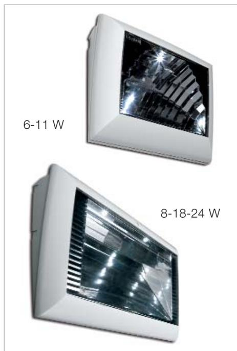
Aparato de elevado rendimiento luminotécnico. Fuente de luz de LED de potencia con 100.000 horas de duración. Cuerpo en policarbonato, pantalla de elevada transparencia. Parábola de amplio radio en policarbonato metalizado con geometría de facetado complejo y planos secuenciales de reflexión. Circuito electrónico de elevada eficiencia con posibilidad de switch SE/SA, 1h, 3h de autonomía.
